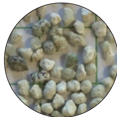
4. fotó SuperPower szemcseszervezet mérés: a granulátum több, mint 95%-a 0,7 és 1,7 mm közötti mérettartományba esik.
